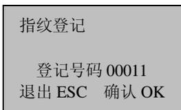
注：指纹机的号码为 5 位，如果您的号码不足五位，机器将自动在数字前加 0，例如您的号码为 11，机器将显示为 00011。
