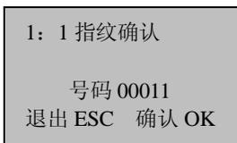
注：指纹机的号码为 5 位，如果您的号码不足五位，机器将自动在数字前加 0，例如您的号码为 11，您只需要输入 11，机器将显示为 00011。
